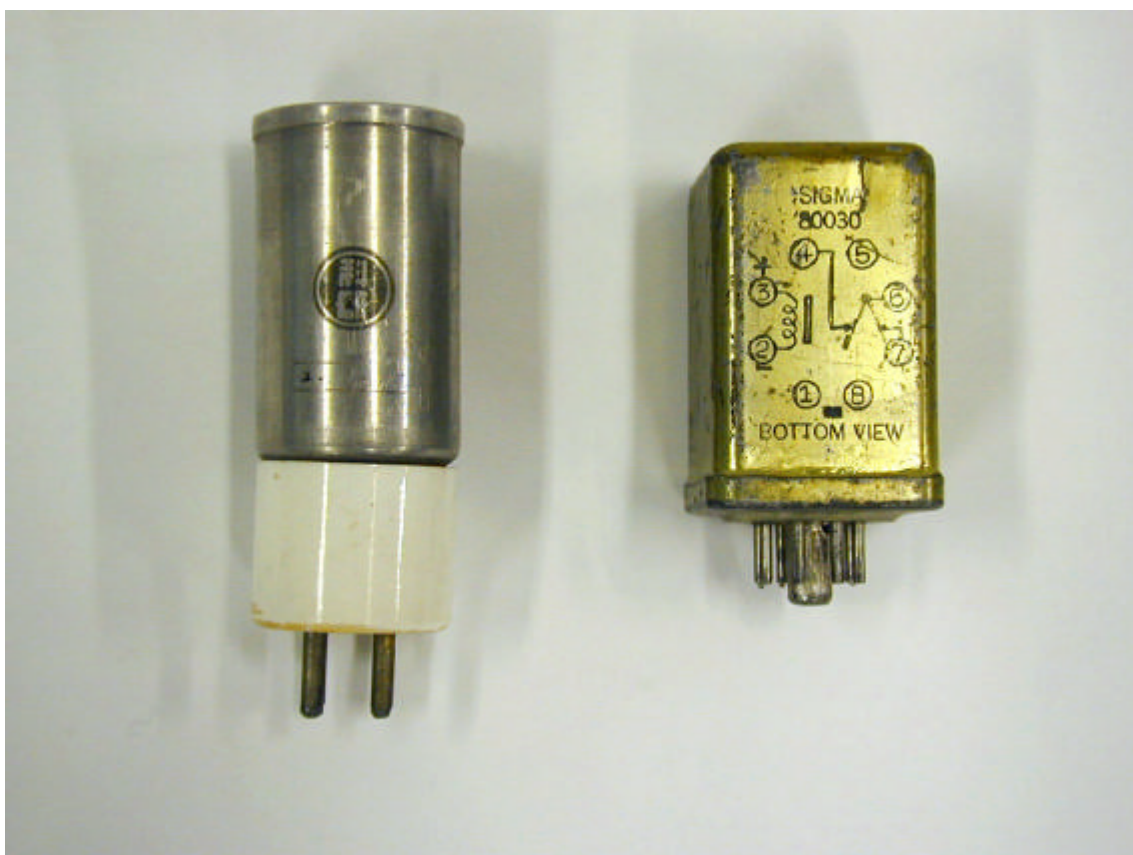
統計数理研究所の初代の物理乱数発生装置（放射線を計数）の部品
